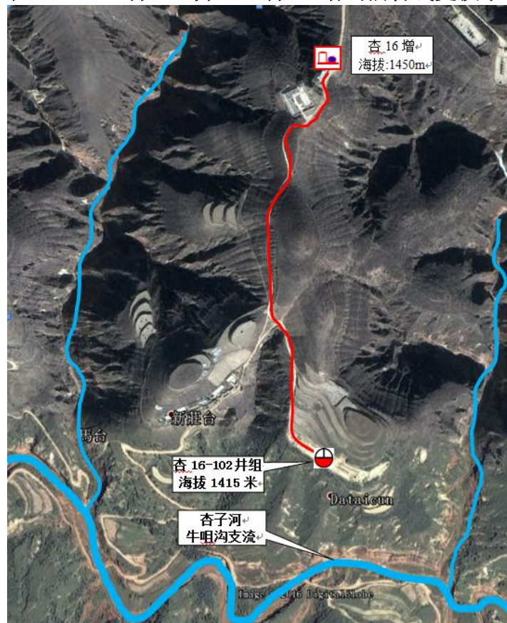
附图 27 杏 16-102 井组至杏 16 增出油管线更换示意图
