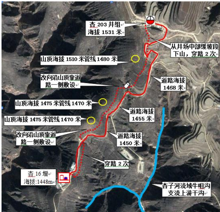
附图 26 杏 203 井组至杏 16 增出油管线更换示意图
