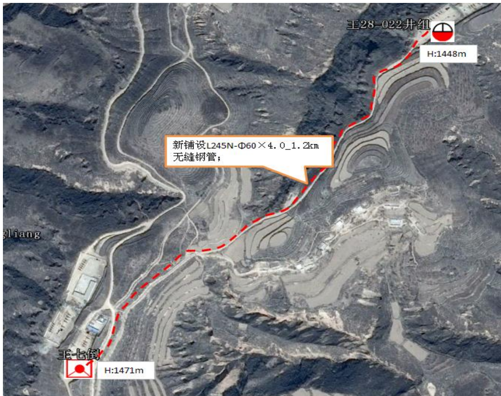
附图 22 王 28-022 井组新敷设出油管线走向示意图
