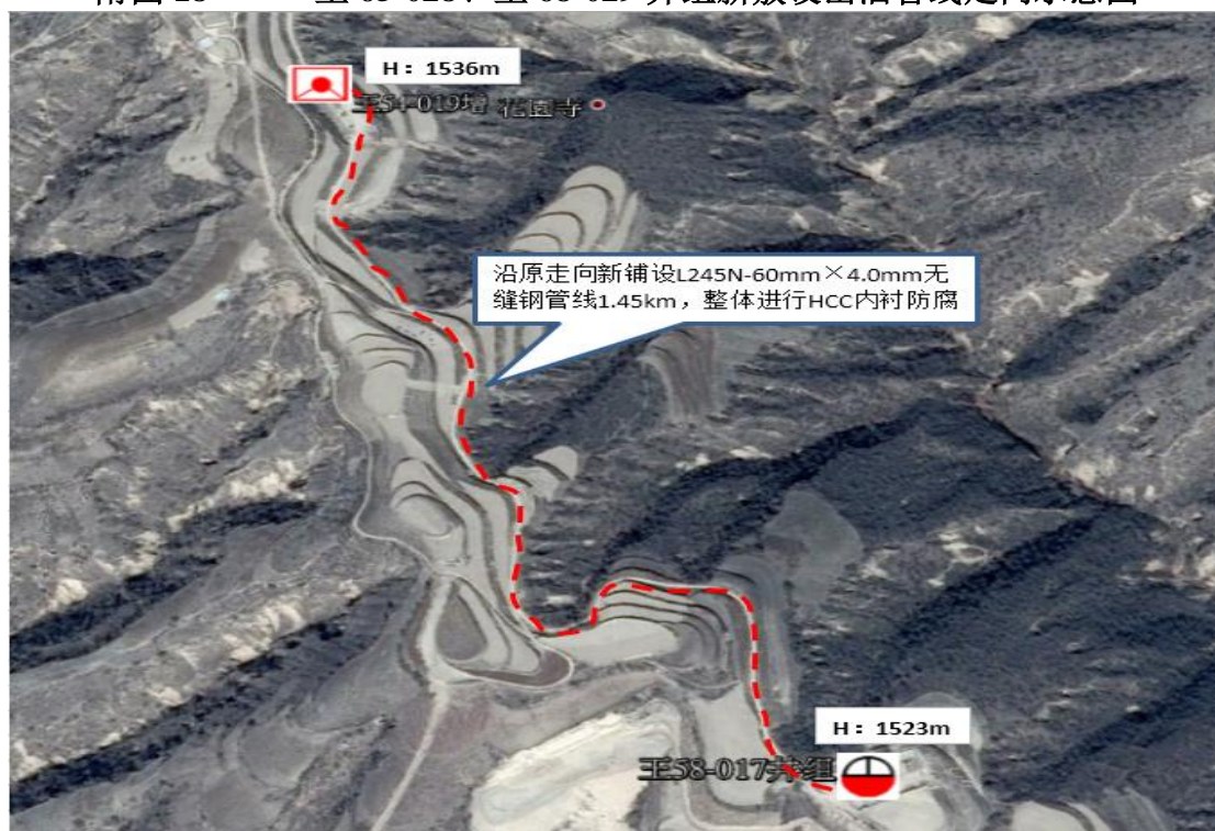
附图 19 王 58-017 井组新敷设出油管线走向示意图
