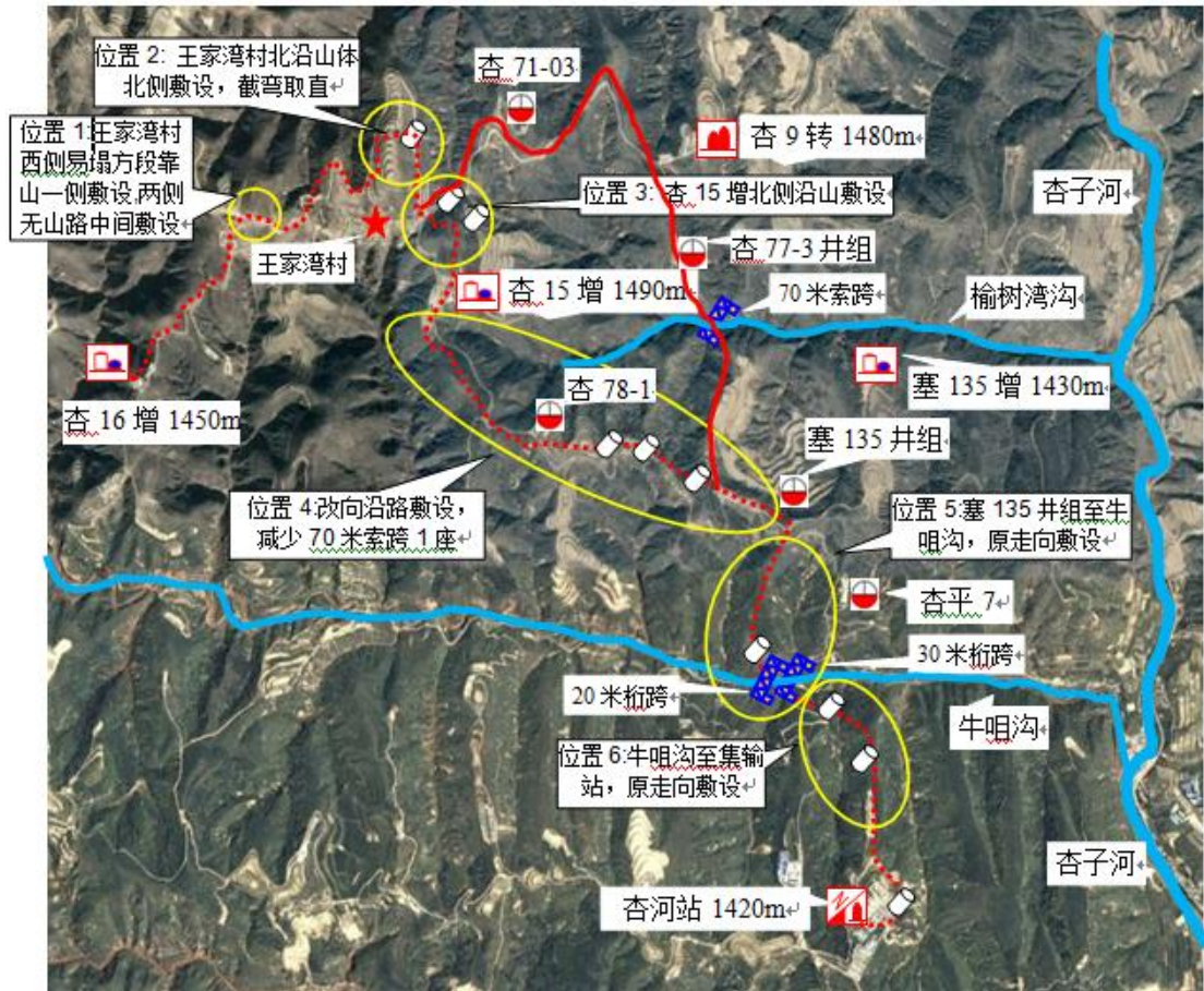
附图 24 杏十六增集油管线走向示意图
