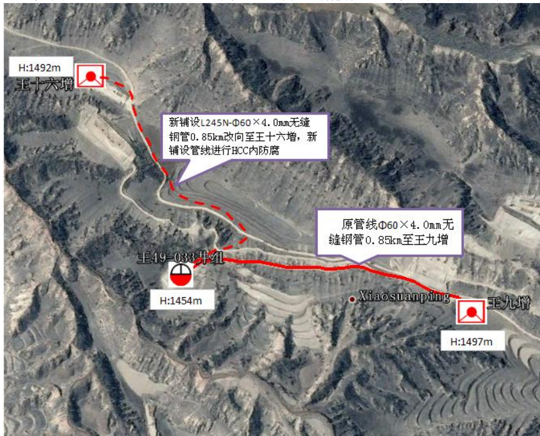
附图 21 王 49-033 井组新敷设出油管线走向示意图
