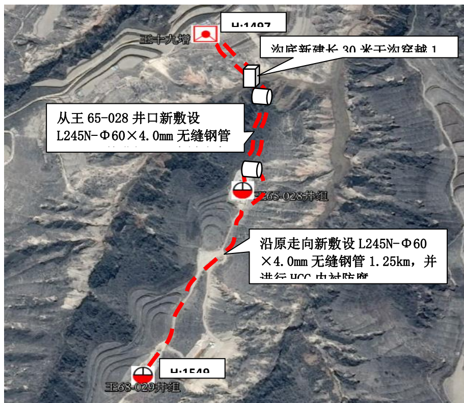
附图 18 王 65-028、王 68-029 井组新敷设出油管线走向示意图
